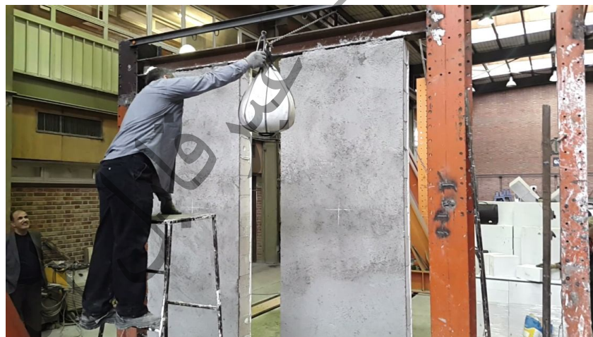
شکل ۳-۶- آزمایش ضربه جسم نرم سنگین
