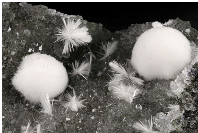
شکل ۱-۷- ساختار بلوری توپرموریت و زونولیت
